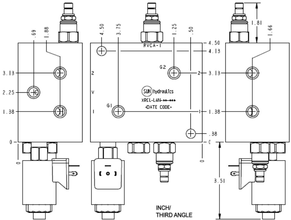
Diese Ventilkombination bietet Entlastung und Doppeldruckbegrenzung. Die Anschlüsse 1 und 2 werden vor Überdruck geschützt. Das Magnetventil schaltet beide Druckbegrenzungsventile. Diese Ventileinheit ist in stromlos geöffnet oder gesperrter Ausführung erhältlich. Stromlos geöffnet bedeutet, dass sich der Druck vor der Bestromung des Magnetventils auf einem niedrigen Niveau befindet. Stromlos gesperrt heißt, dass sich der Druck vorher auf einem hohen Niveau befindet.
